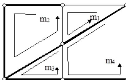
Figura 4. Representación de las mallas en un circuito.
